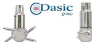
Tra i sistemi di lavaggio Dasic offerti da Exonder, siamo a presentare la sfera di lavaggio orbitale che permette di pulire con estrema efficacia l'intera superficie interna del serbatoio: essa sfrutta la pressione del fluido pulente in ingresso per permettere la rotazione simultanea della testa della sfera sull'asse orizzontale e verticale.
